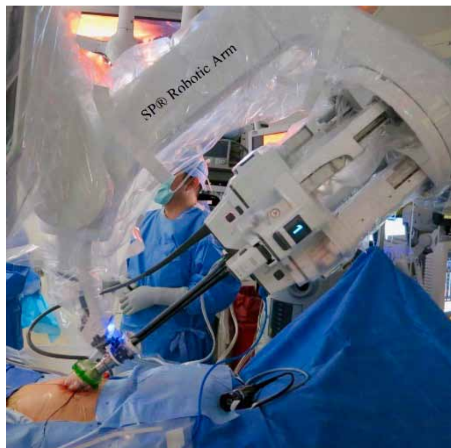
Figura 1. Los sistemas quirúrgicos SP da Vinci consisten en un solo brazo robótico. Se pueden realizar procedimientos como la prostatectomía extraperitoneal manteniendo al paciente en posición plana supina.
